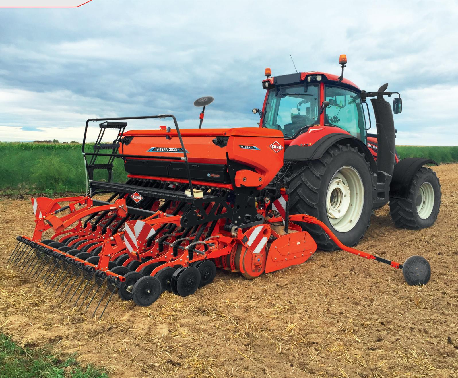
Die Baureihe der mechanischen Aufbaudrillmaschinen SITERA 3010/3020/3030 wird um die Modelle SITERA 3010/3020/3030 e mit elektrischem Dosierantrieb erweitert. Dafür sind die Maschinen auf der rechten Seite mit einem Elektromotor und mit einem Radarsensor für die Geschwindigkeitserfassung ausgerüstet. Für die Saatüberwachung stehen das Terminal VT30 oder eine ISOBUS-Ausführung mit den Terminals CCI 800 oder 1200 oder jedes andere ISOBUS-Terminal zur Auswahl.
