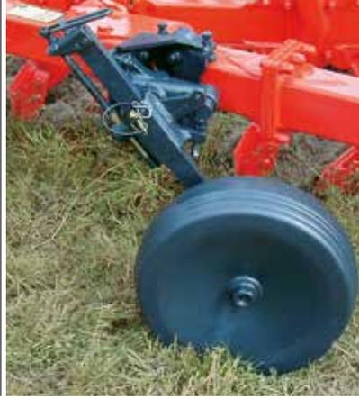
PENDELSTÜTZRAD MIT SPINDELVERSTELLUNG UND MEHREREN ANBAUPOSITIONEN AM PFLUGRAHMEN
