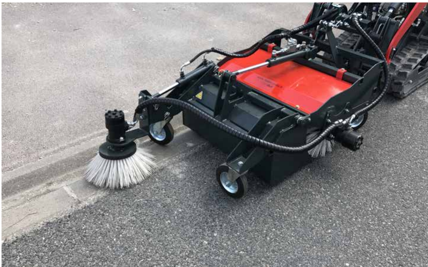
Balayeuse à axe horizontal pour microBull, avec brosse latérale et bac récupérateur
