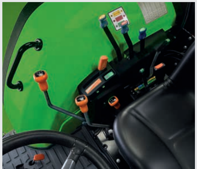
↑ Neue Anordnung der Bedienelemente für die Zusatzsteuerventile und EasyLift-Funktion für den Heckkraftheber.
