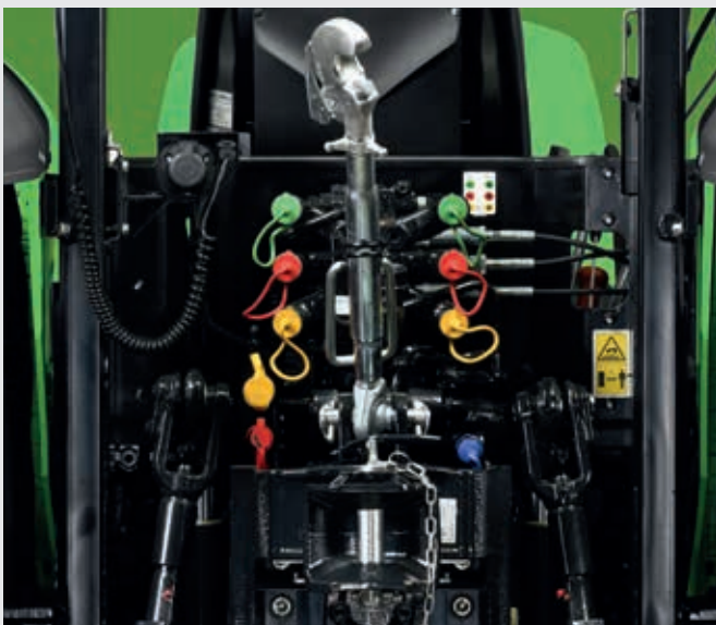
↑ Bis zu 3 Zusatzsteuerventile mit Durchflussregler und drucklosem Rücklauf.
