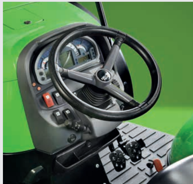
Verstellbare Lenksäule und digital-analoge Instrumententafel.
