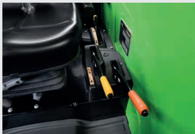
↑ Zapfwellendrehzahl-Vorwahl und Zapfwellenzuschaltung mechanisch.
