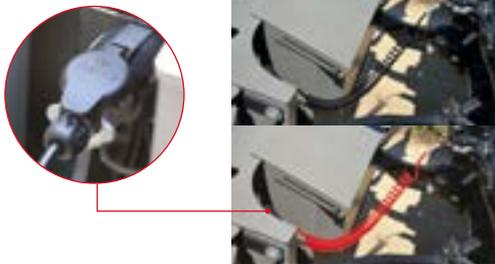
Integrierter 7-poliger Stecker mit 3-m-Spiralkabel (Stecker/Stecker) für eine saubere und sichere Verbindung.
