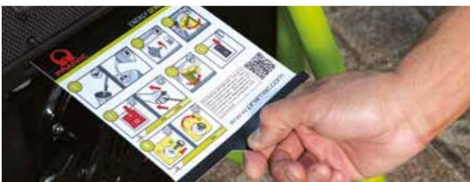
Eine Kurzbetriebsanleitung ist als unverlierbare, herausziehbare Kunststoffkarte in das Bedienpanel integriert und damit immer vor Ort verfügbar.
