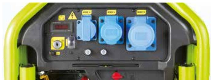
Das Bedienpanel im Carbon design befindet sich geschützt an der oberen Stirnseite des Stromerzeugers. Alle Funktionen sind von dort bedienbar (Start/Stop, Choke, Kraftstoffhahn, Gerätesicherung, Steckdosen, Transportbügel).
