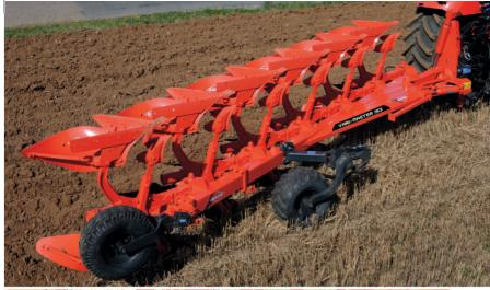
Das in Längsrichtung versetzbare Stützrad ist mit einer senkrechten Drehachse ausgerüstet, welche eine präzise Anpassung an die eingestellte Schnittbreite gewährleistet. Bemerkenswert die einfache und genaue Arbeitstiefeneinstellung über eine Kurbel oder Hydraulikzylinder (Einstellung für beide Pflugseiten getrennt möglich).
