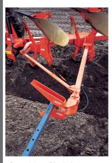
Der seitlich am Pflug befestigte Packerarm ermöglicht den Einsatz eines Pflugnachläufers einschließlich der hydraulischen Ausklinkung am Vorgewende.
