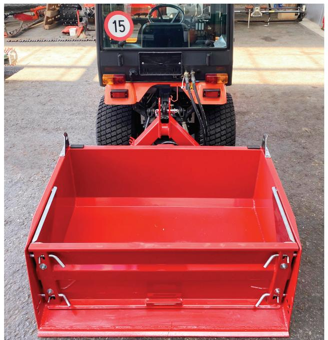
Schwenkbare, leicht abnehmbare Bordwand
