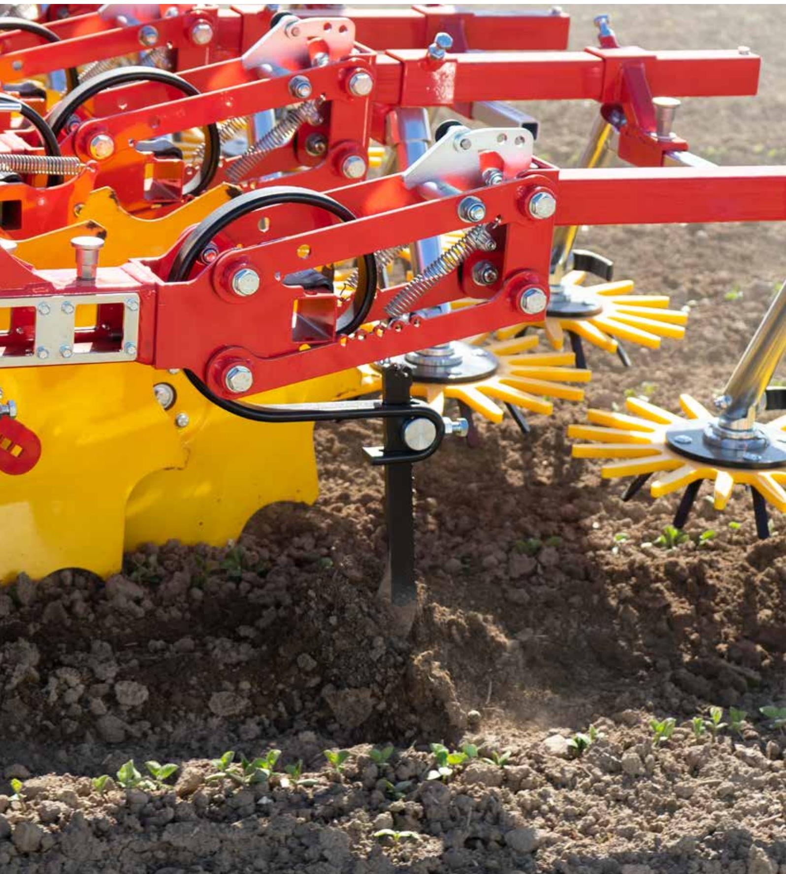
Das neue Hackgerät FLEXCARE von PÖTTINGER bietet dank seines einzigartigen Konzeptes volle Flexibilität für den Einsatz in unterschiedlichen Kulturen. Der Reihenabstand, die Arbeitsbreite der Hackelemente und die Feineinstellungen der Fingerhacke sind komplett werkzeuglos verstellbar. Eine exakte Tiefenführung und eine kulturschonende Arbeitsweise zeichnen die Maschine aus.
