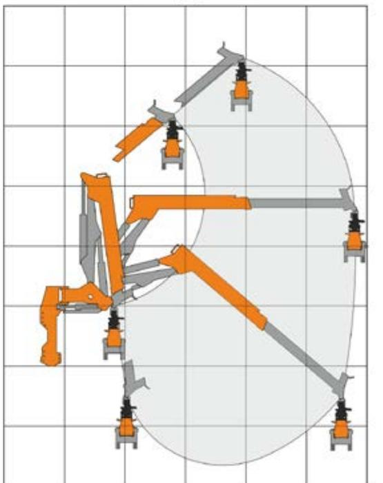
Hubkraft in kg bei 180bar ohne Greifer 2700 1600 1150 900
