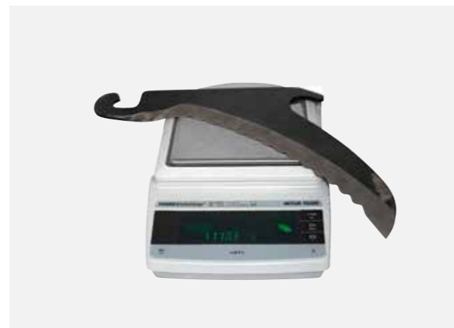
Messer bis zur max. Verschleißgrenze geschliffen: 1,1 kg.
