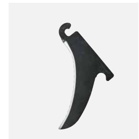
Falsch geschliffenes Messer: Kleinere Ausprägung des Wellenschliffs.
