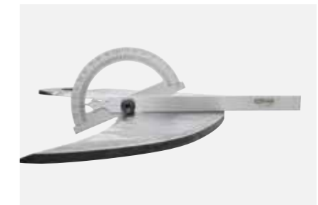
Falsch geschliffenes Messer. Winkel ca. 22°.
