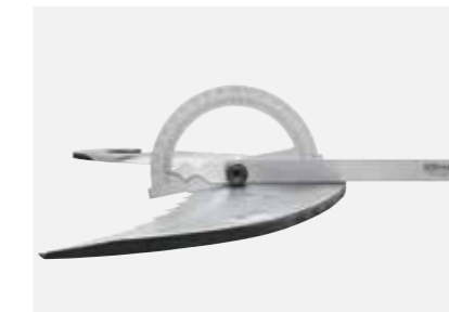
Richtig geschliffenes Messer. Winkel ca. 10°.
