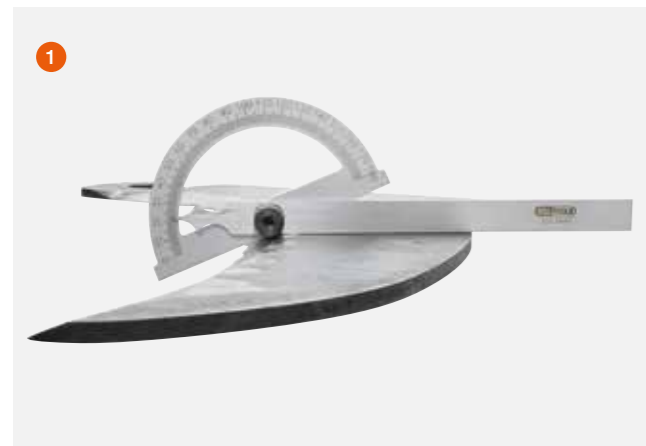
Messer mit falschem Schleifwinkel (22°), geschliffen mit Handschleifgerät.
