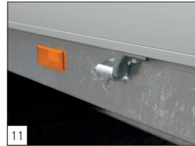
**Serienausstattung:** ingenieüser Entwurf der HAPERT-Scharniere für eine äußerst praktische Befestigung z.B. des Ladungsnetzes.
