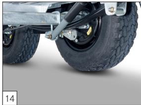
**Option:** Die Modelle in 3500 kg ZGG können ab 335 x180 cm mit Parabelfederung inkl. Stoßdämpfern ausgeführt werden. Bei Bereifung 195/50 R13 oder 185/70 R 13C inklusive schwarzer Felgen.
