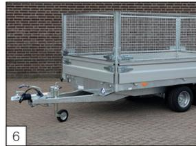
**Option:** Gitter-Aufsatz mit Klappverschlüssen, abnehmbar und pendelbar.
