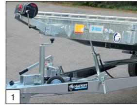
**Serienausstattung:** einer doppelt wirkenden Hydraulik-Pumpe, eine 3,5to-Auflaufeinrichtung und eine feste Combi Protect Rail (80mm hoch) montiert.
