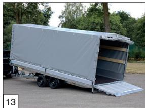
**Option:** die Plane und Spriegel sind nur möglich bei Modelle mit Aluminium Bordwände.
