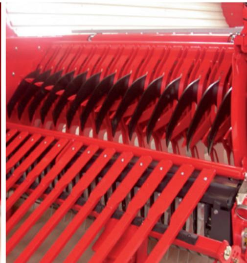
Der Rotor läuft sehr leise und rund – bei hoher Förderleistung. Die Zinken und Abstreifer sind aus hochfestem Vergütungsstahl. Auf einer Ebene befinden sich 14 Messer, welche beste Schnittqualität und eine theoretische Schnittlänge von 11 cm mit insgesamt 56 Schneidphasen pro Umdrehung garantieren. Der Rotor ist extrem wartungsarm – nur 2 Schmiernippel an den Hauptlagern.
