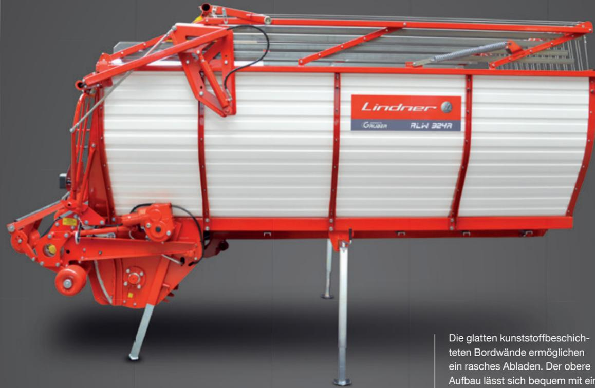
Die glatten kunststoffbeschichteten Bordwände ermöglichen ein rasches Abladen. Der obere Aufbau lässt sich bequem mit einer Kurbel auf die gewünschte Höhe einstellen.
