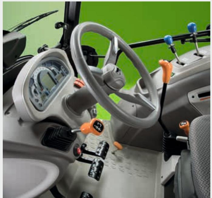
5-Gang-Getriebe mit mechanischem Wendegetriebe, Wendschaltung an der Lenkkonsole.
