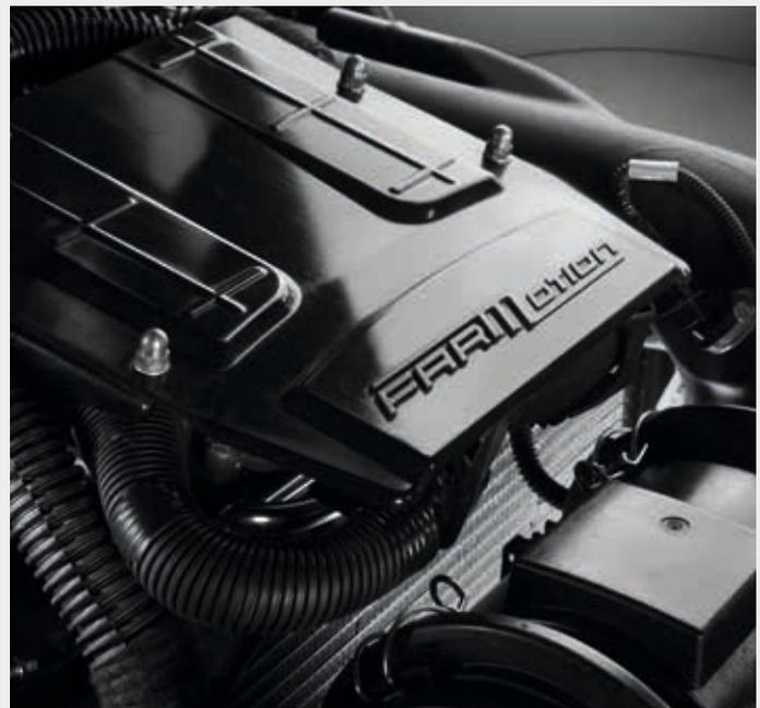
Abgasstufe-V-konforme FARMotion 35-Motoren mit Common-Rail-Einspritzung und einer Leistung von bis zu 102 PS.
