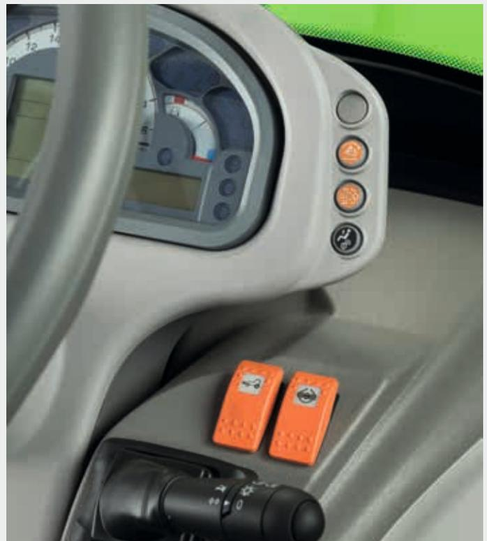
↗ Elektrohydraulische Zuschaltung für Allradantrieb und Differenzialsperre
