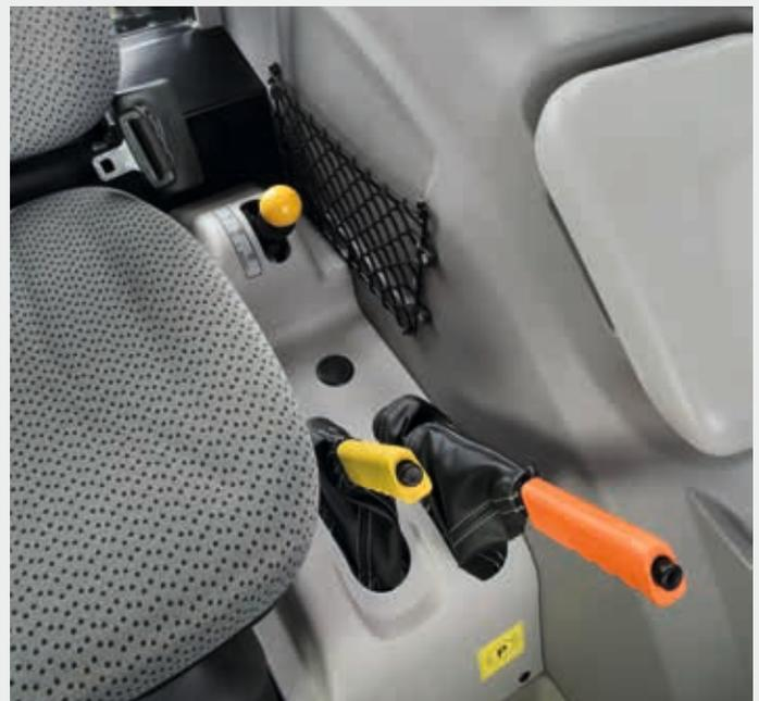
Bis zu 3 Zapfwellendrehzahlen mit mechanischer Zuschaltung.
