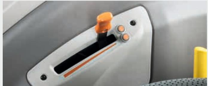
Handgashebel mit zwei elektronisch speicherbaren Motordrehzahlen.
