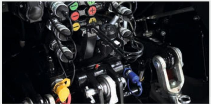
↑ Bis zu 3 Zusatzsteuerventile im Heck mit Durchflussregler und drucklosem Rücklauf.
