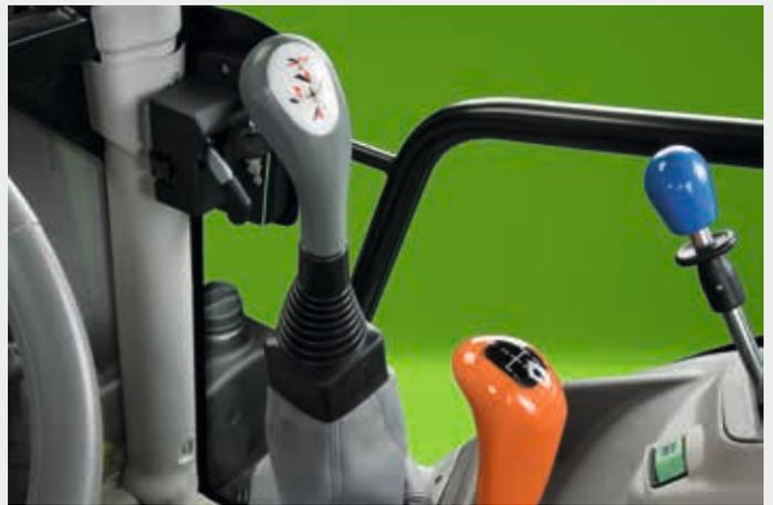
👉 Vollständig integrierter Frontlader-Joystick.
