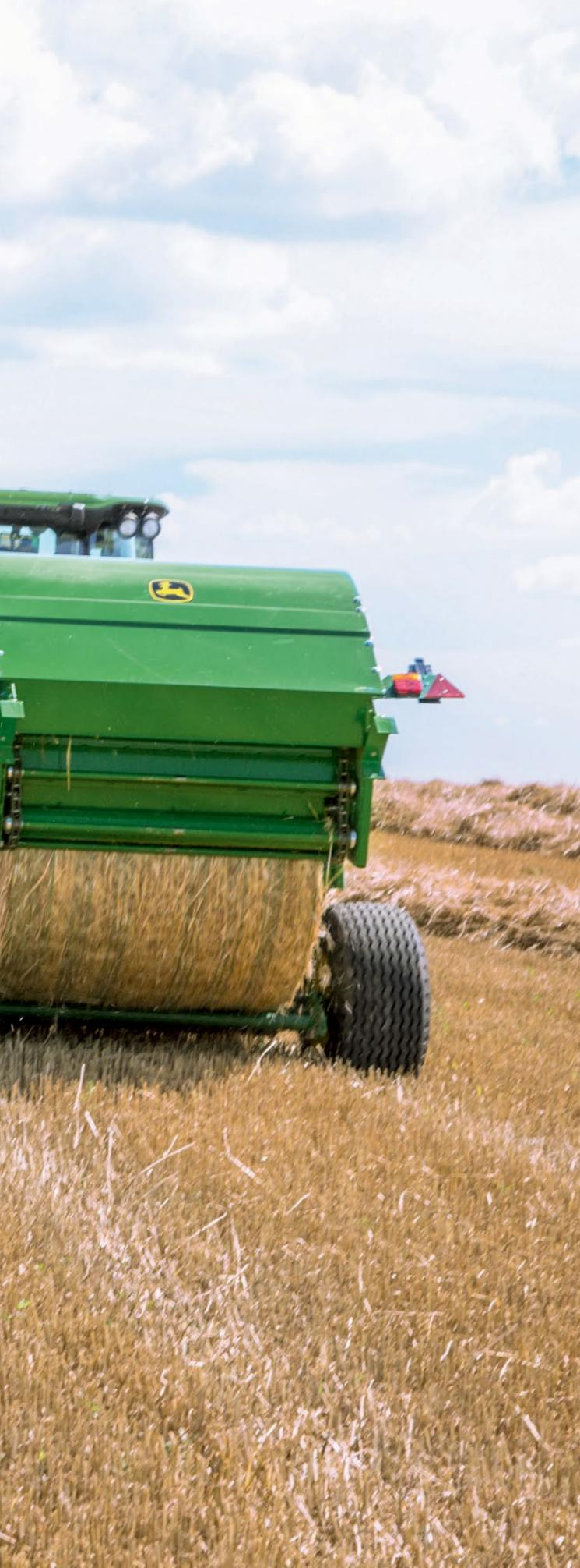
Durch die zwei unterschiedlichen Kammergrößen können Sie dicht gepresste Ballen mit einem Durchmesser von 1,20 oder 1,50 m erhalten.
