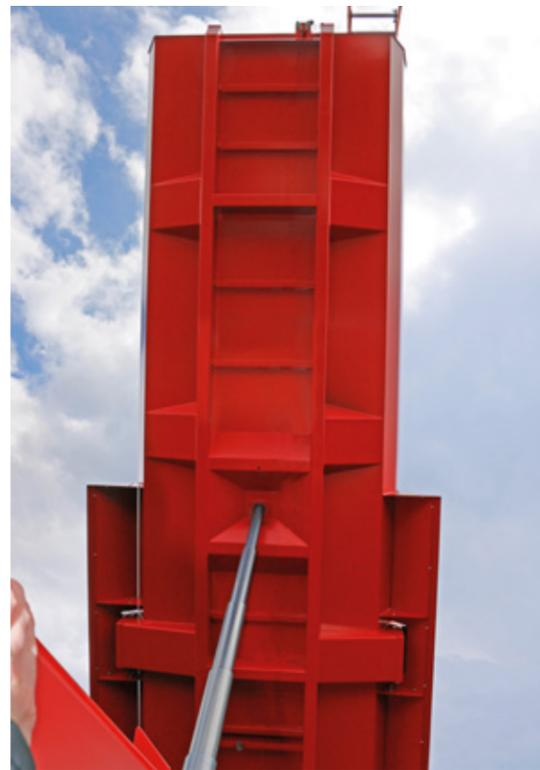
Die Bodengruppe ist von unten stark verrippt. Die Wannenunterzüge sind aus massiven Rechteckrohren 200 x 100 mm gefertigt (glatte Innenflächen!). Die Ausleger unter der Wanne sowie Mittel- und Eckrungen sind ringsum gegen Korrosion verschweißt.
