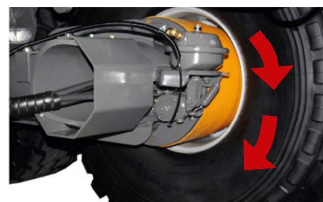
Der hydraulische Radantrieb sorgt für mehr Schubkraft im Gelände, die gewichtssparende Antriebskonfiguration steigert die Traktion.
