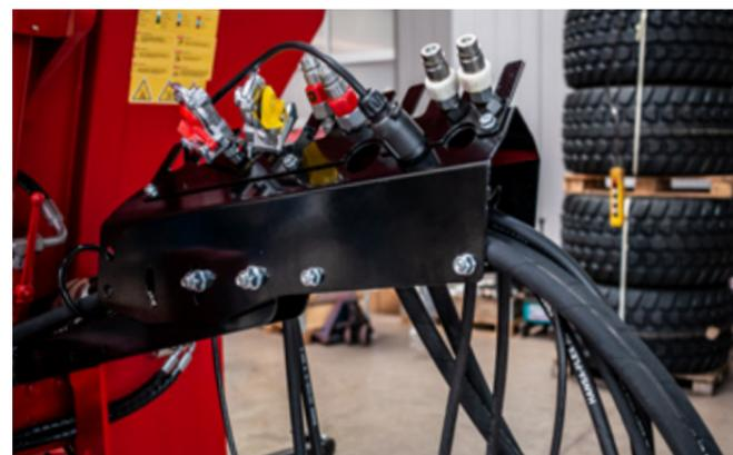
Ein robuster Schlauchhalter schafft Ordnung und der verstellbare Anfahrerschutz ermöglicht eine Anpassung an Ihren Schlepper. Die Anhängöhe kann fast stufenlos eingestellt werden.
