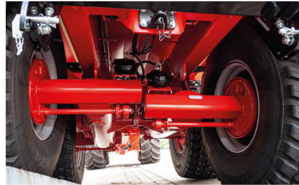
Beim Pendelaggregat sind die Achsen asymmetrisch versetzt (55/45), das verhindert ein „Eingraben“ der Vorderachse und sorgt somit für eine hervorragende Geländegängigkeit und Standfestigkeit. Die runden Pendelarme haben einen selbsttreibenden Effekt. Ein ALB-Ventil gehört zur Serienausstattung.
