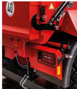
Die massiven Faust-Kipplager der SK-Baureihe haben einen durchgehenden 40 mm Bolzen. Diese spielfrei gelagerte Konstruktion läuft seit über 30 Jahren störungsfrei.
