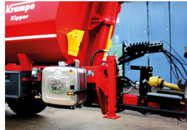
Eine eigene Ölversorgung mit Antrieb über Zapfwelle oder Ölmotor ist auf Wunsch lieferbar.
