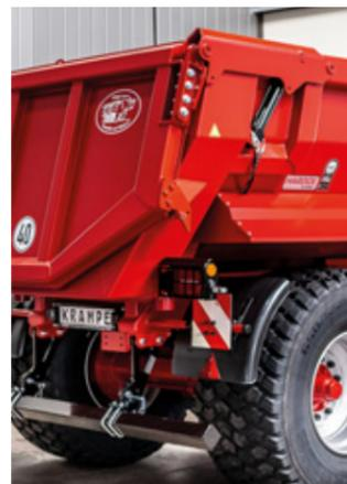
Die HP- und HD-Baureihe sind mit einer hydraulisch öffnenden Pendel-Heckklappe mit Schneidkante ausgerüstet.
