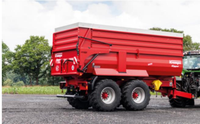
Die hydraulische Heckklappe der SK-Baureihe wurde vom „BigBody“ übernommen, Ausführung mit außenliegendem doppelwirkenden Zylinder und außenliegenden Schließhaken mit Anpressung unten. Der optionale Auslaufschieber kann für rieselfähige Güter verwendet werden.
