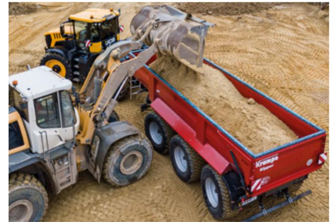
Eine umlaufende Stoßkante aus Kunststoff schützt die Rahmenkronen bei der Beladung mit dem Radlader.
