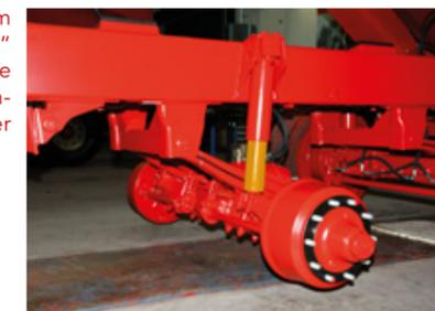
Kaum ein Hersteller hat so viel Erfahrung im Bau hydraulischer Fahrwerke wie Krampe. Die serienmäßigen Schutzrohre verhindern Steinschlag auf den doppeltverchromten Kolbenstangen.
