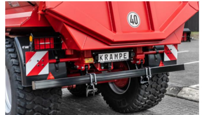
Der hochklappbare Unterfahrerschutz bietet optimale Bodenfreiheit in schwierigem Gelände.
