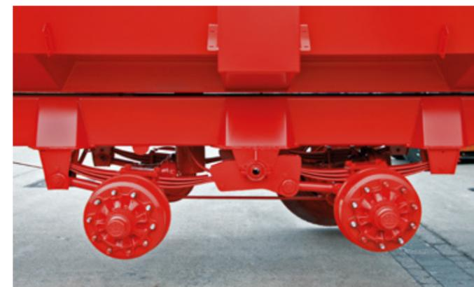
24–32 t Parabelfedern mit Längslenkern, breiter Federmitte und einem Achsabstand von 1,36 oder 1,55 m.
