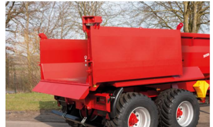
Die Pendel-Schwenklappe dient als Ergänzung zur Sörling-Heckklappe. Sie wird oberhalb pendelnt gelagert und ist zusätzlich in Fahrtrichtung nach rechts aufschwenkbar.
