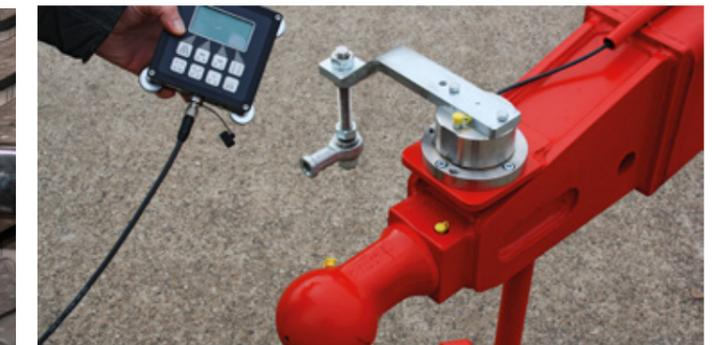
Bei der elektronisch gesteuerten Zwangslenkung kann der Fahrer durch verschiedene Programme die Lenkreaktionen des Anhängers bewusst selbst steuern.
