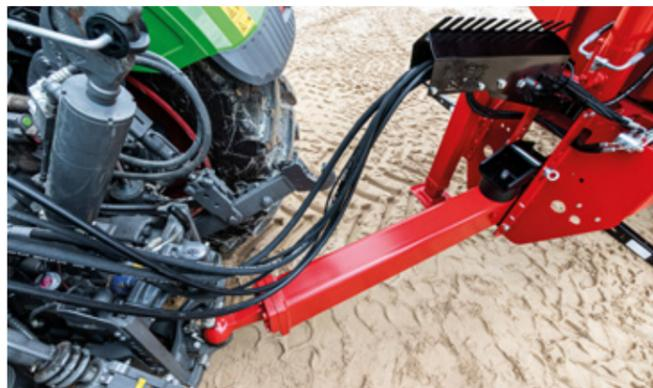
Die höhenverstellbare Zugvorrichtung hat zwei Gummisilentblöcke und kann 4 t Stützlast übertragen.
