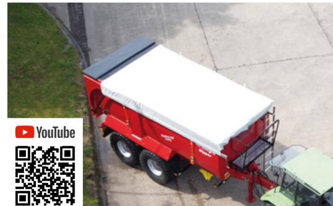
Die Wickelplane kann direkt auf der Grundwanne befestigt werden. Aber auch auf Silageaufsätzen ist der Einsatz von einer Wickelplane problemlos möglich, lieferbar für SK-Modelle.
