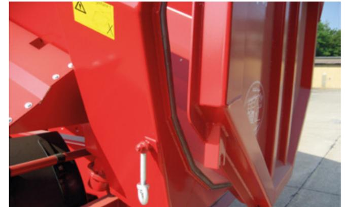
Bei Ladung mit hohem Feuchtigkeitsgehalt sorgt die wasserdichte Heckklappe für einen sicheren Transport.
