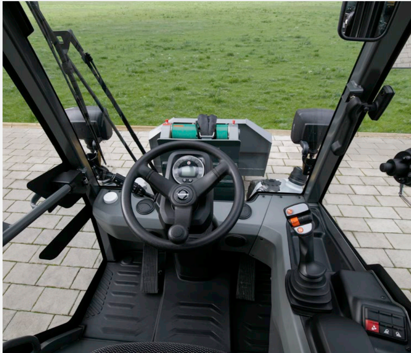
Komfortabler Joystick: Wechsel zwischen Hase und Schildkröte direkt auf dem Joystick möglich.
