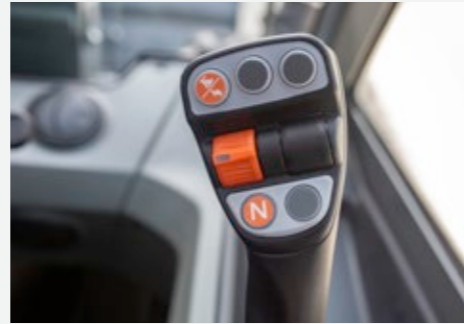
Komfortabler Joystick: Wechsel zwischen Hase und Schildkröte direkt auf dem Joystick möglich.
