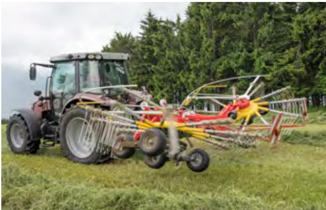
Durch den Dreipunkt Schwenkbock folgt Ihr Mittenschwader bei Kurvenfahrten spurtreu dem Traktor. Die beidseitigen Dämpfstreben zentrieren und stabilisieren die Maschine auch bei Querfahrten am Hang. Beim Hochheben verriegeln sich die Kreisel hydraulisch in der Mittelstellung.
