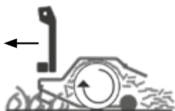
Offene Heckhaube: Grasmulchen bei niederm Leistungverbrauch
