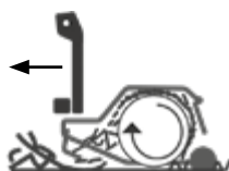
Geschlossene Heckhaube: feines Zerkleinern von Schnittholz und Sträuchern
