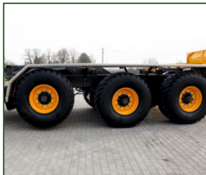
STR-410 Hydraulische Federung. Entwickelt für schwerere Anwendungen, sowohl auf der Straße als auch im Gelände.
