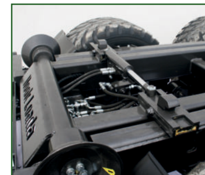
STR-701 Hydraulische Containerverriegelung.
