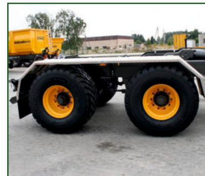
STR-406 24t Parabelfederung, 1810mm Abstand zwischen Achsen.
