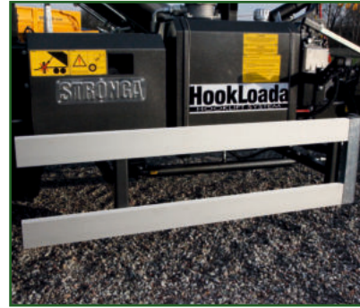
STR-1001 Seitenschutzschienen aus Aluminium - ultraleicht, aber extra stark.
