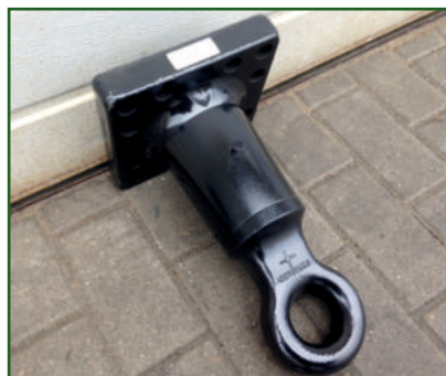
STR-506 Anschraubbare schwenkbare Anhängerkupplung, Scharmüller-Typ. Öse mit 50 mm Durchmesser.
