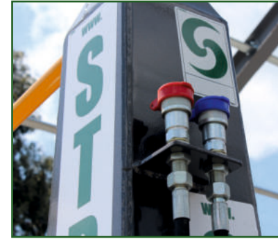
STR-710 Hydraulikanschlüsse am Hakenturm mit Umschaltventil.
