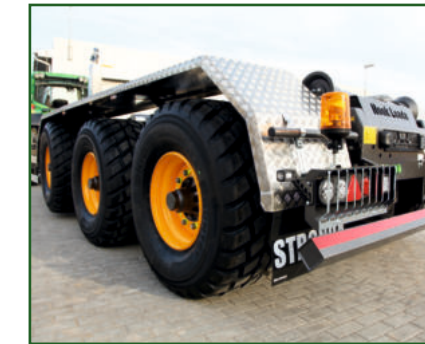
STR-900 Ultraleichte Aluminium Kotflügel in voller Länge.
