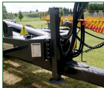
STR-601 Hydraulischer Stützfuß. Andere Stützfüße erhältlich - manueller Teleskop-, manuell getriebener oder aufgehängter Schuh.
