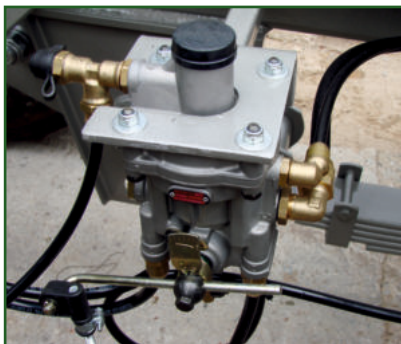
STR-304 Load Sensing Valve (ALB) für Luftbremse.
