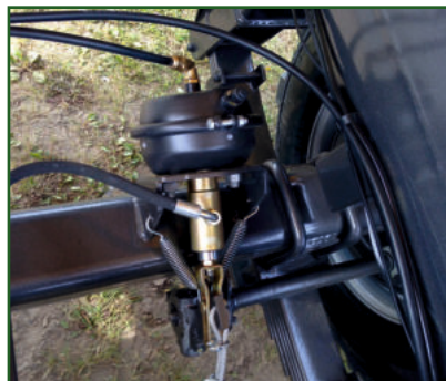
STR-305 Doppeltes Bremssystem (Luftbremse und hydraulische Bremse).
