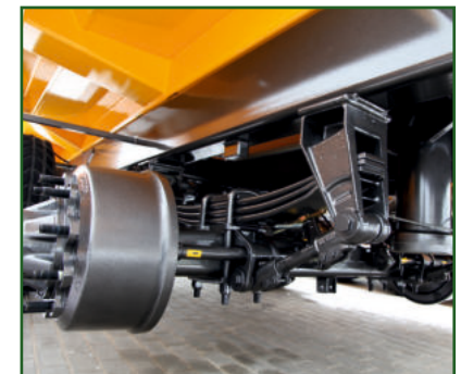
STR-407 32t Parabelfederung, 1810mm Abstand zwischen Achsen.
