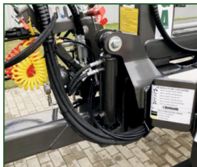
STR-508 Hydraulische Deichsel für einfaches Nivellieren und hohen Komfort.
