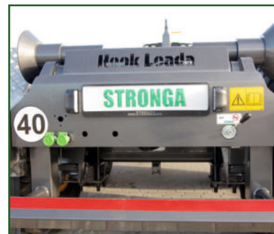
STR-700 Zusätzliche Hydraulikanschlüsse mit Umschaltventil an der Rückseite des Anhängers.
