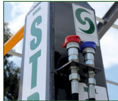
STR-724 Hydraulikanschlüsse mit elektrischem Umschaltventil am Hakenturm.
