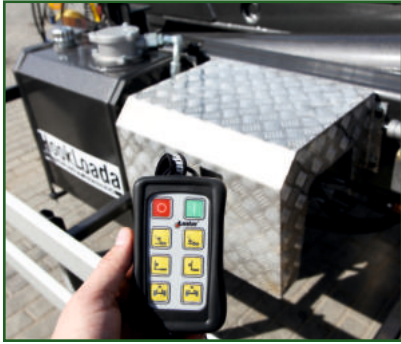
STR-704 Unabhängiges Hydrauliksystem mit Zapfwelle, 130 l / min Pumpe. Steuerung über Fernbedienung.
