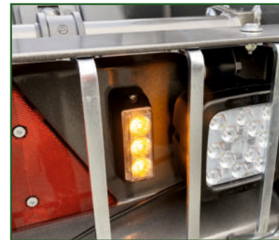
STR-1040 Zwei LED-Blinklichter, die in einem sicheren Gehäuse hinten am Anhänger untergebracht sind.
