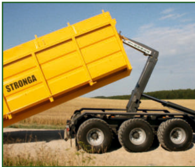
STR-713 QuickLoada™ - schnelles aber kontrolliertes Kipp- und Entladesystem.
