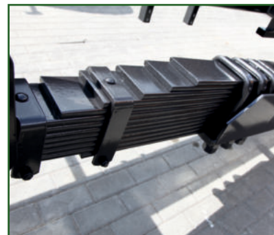
STR-501 Gefederte Deichsel für hohen Komfort bei Geschwindigkeit.
