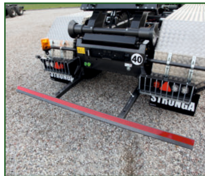
STR-1008 Manuell ausziehbare, extra starke Heckstoßstange.
