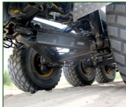
STR-411 Vorderachse - Nur mit Luft- oder Hydraulikfederung.
