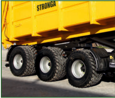
STR-903 Superharte Viertel Kunststoff-Kotflügel vorne und hinten.
