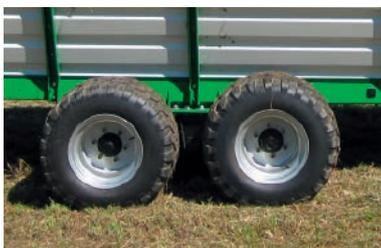
Châssis tandem suspendu
