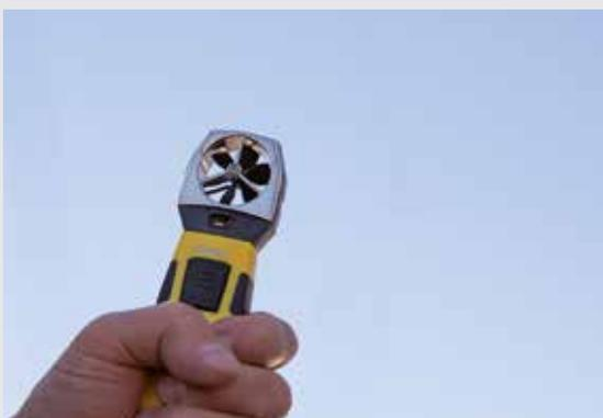
**Bluetooth Windmeter**, kabellose Windmessanzeige
