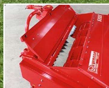
Ouverture de la machine pour entretien ou nettoyage
