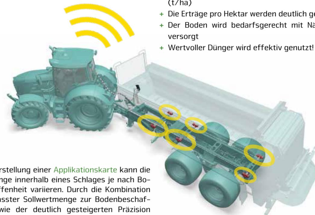
Durch die Erstellung einer Applikationskarte kann die Sollwertmenge innerhalb eines Schlages je nach Bodenbeschaffenheit variieren. Durch die Kombination aus angepasster Sollwertmenge zur Bodenbeschaffenheit sowie der deutlich gesteigerten Präzision beim Ausbringen durch das dynamische Wiegesystem maximieren Sie Ihren Ertrag erheblich. Alle gängigen Formate der Applikationskarten lassen sich ganz einfach über einen USB-Stick einlesen.
