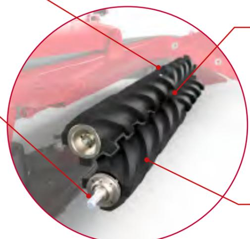
Der Anpressdruck der Gummi-Profilelemente kann variabel an die verschiedenen Futter- und Witterungsverhältnisse angepasst werden.
