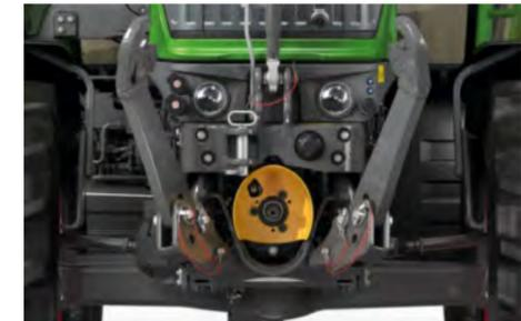
Die Hydraulikkupplungen im Heck sind, sauber versetzt nebeneinander, farblich gekennzeichnet. Die Staubkappen schließen selbstständig. Für leichtes Ankuppeln sind die Anschlüsse versetzt und unter Druck kuppelbar.
