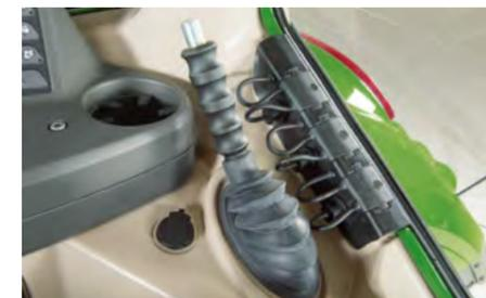
Für Kabel, die vom Heck in die Kabine geführt werden müssen, bietet Fendt eine ausgeklügelte Lösung an. Unabhängig vom Querschnitt kann jedes Kabel sauber durch die Durchführung verlegt werden. Die Heckscheibe kann dabei geschlossen werden und Staub, Schmutz, Wasser und Geräusche bleiben draußen.
