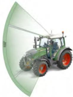
Für eine überragende Übersicht mit imposanten 100 Grad Sichtwinkel sorgt das integrierte Dachfenster. Somit haben Sie das volle Sichtfeld, vom ausgehobenen Frontlader bis hinunter zu den Radeinläufen.
