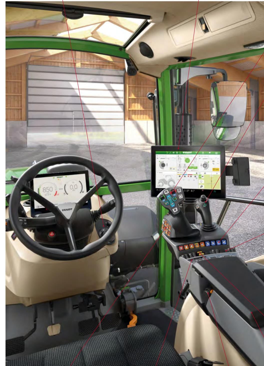
Der neue Multifunktions-Joystick enthält neben der vertrauten Kleeblatt-Bedienung zwei Bedienelemente für die proportionale Ventilsteuerung sowie vier frei belegbare, weiße Tastenfelder.
