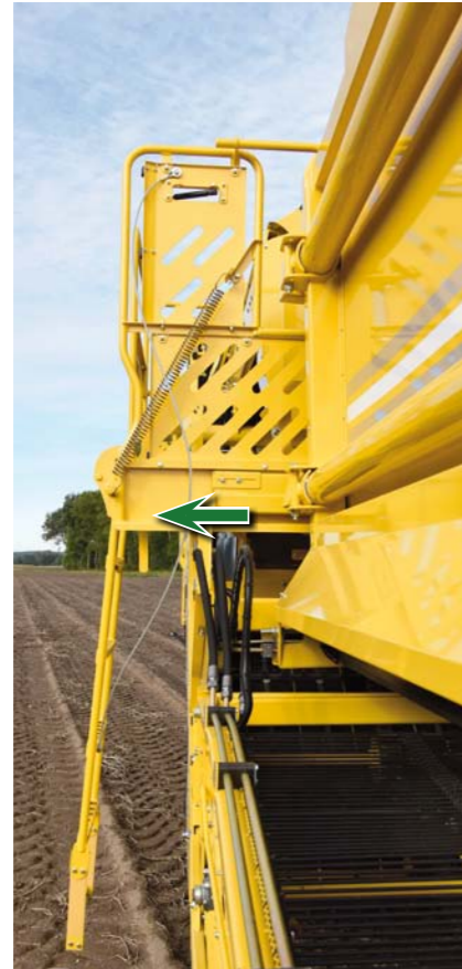
Arbeitspodest, 300 mm ausschiebbar - großzügige Arbeitsfläche für mehr Bewegungsfreiheit
