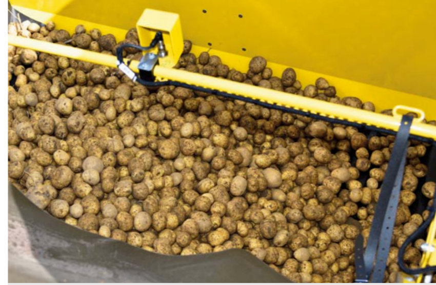
Ultraschallsensor für die Bunkerbefüllautomatik
