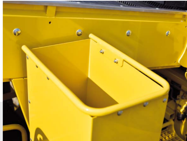
Großzügig dimensionierte Abwurfschächte
