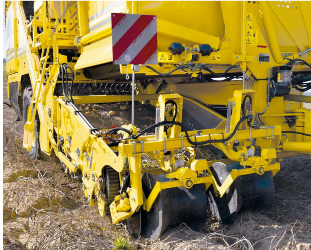
Dammtrommeln aus Kunststoff, hydraulisch angetriebenes Scheibensech aussen
