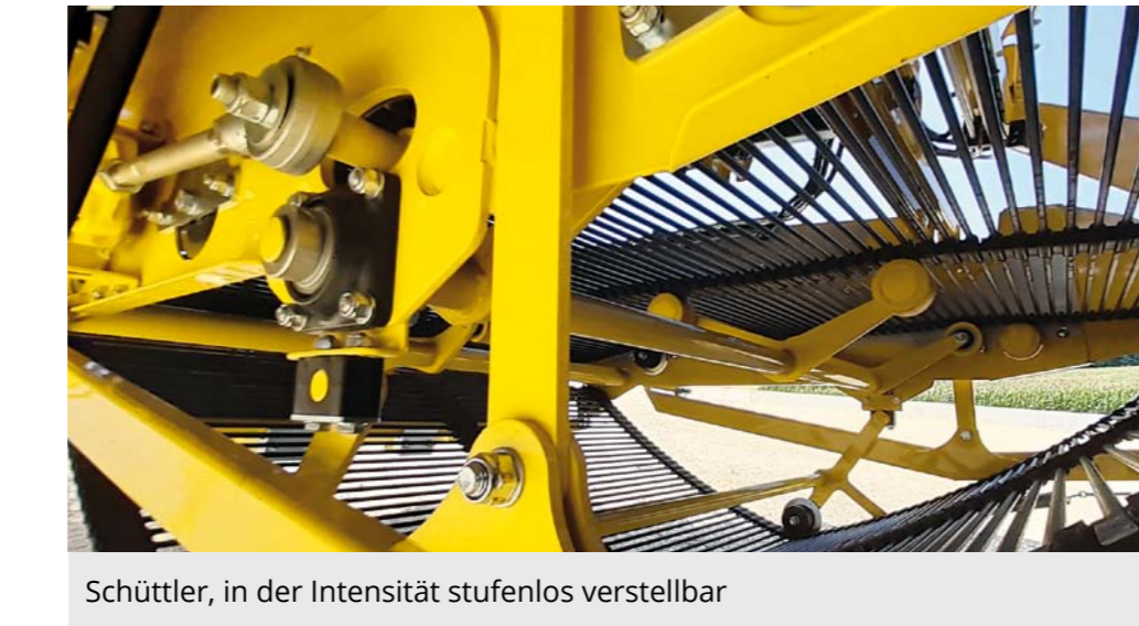
Großflächige Siebketten, hervorragende Beimengenabscheidung
