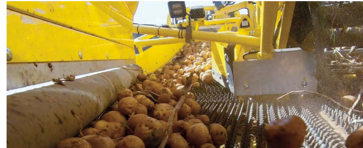
Produktstrom auf Igel 1, Igel 2 + Ableitwalzen und Igel 3
