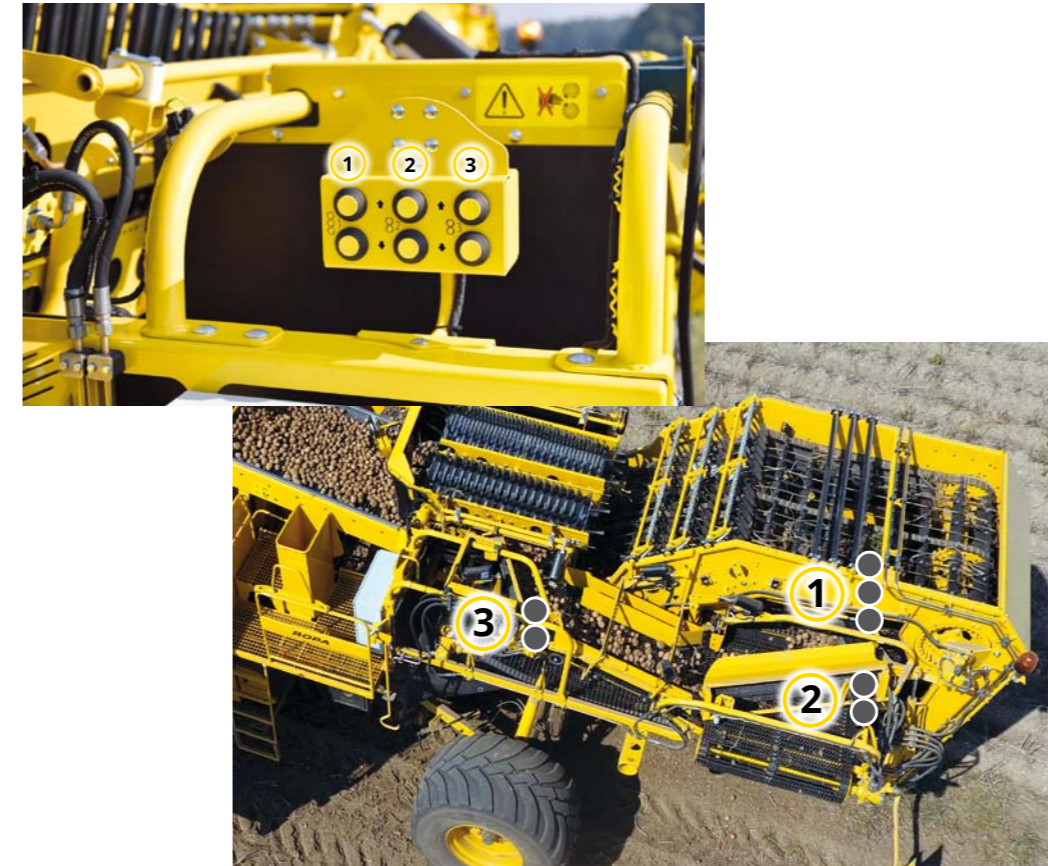
Höhe und Neigung der Trennaggregate sind bequem per Knopfdruck stufenlos hydraulisch und elektronisch anpassbar
