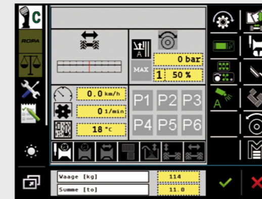
Liveansicht der Wiegedaten unterhalb der gewohnten Terminalbedienung
