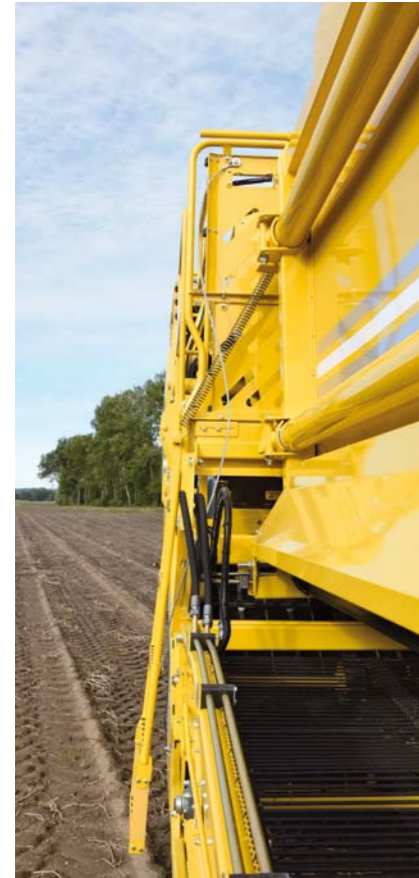
Arbeitspodest, 300 mm ausschiebbar - großzügige Arbeitsfläche für mehr Bewegungsfreiheit
