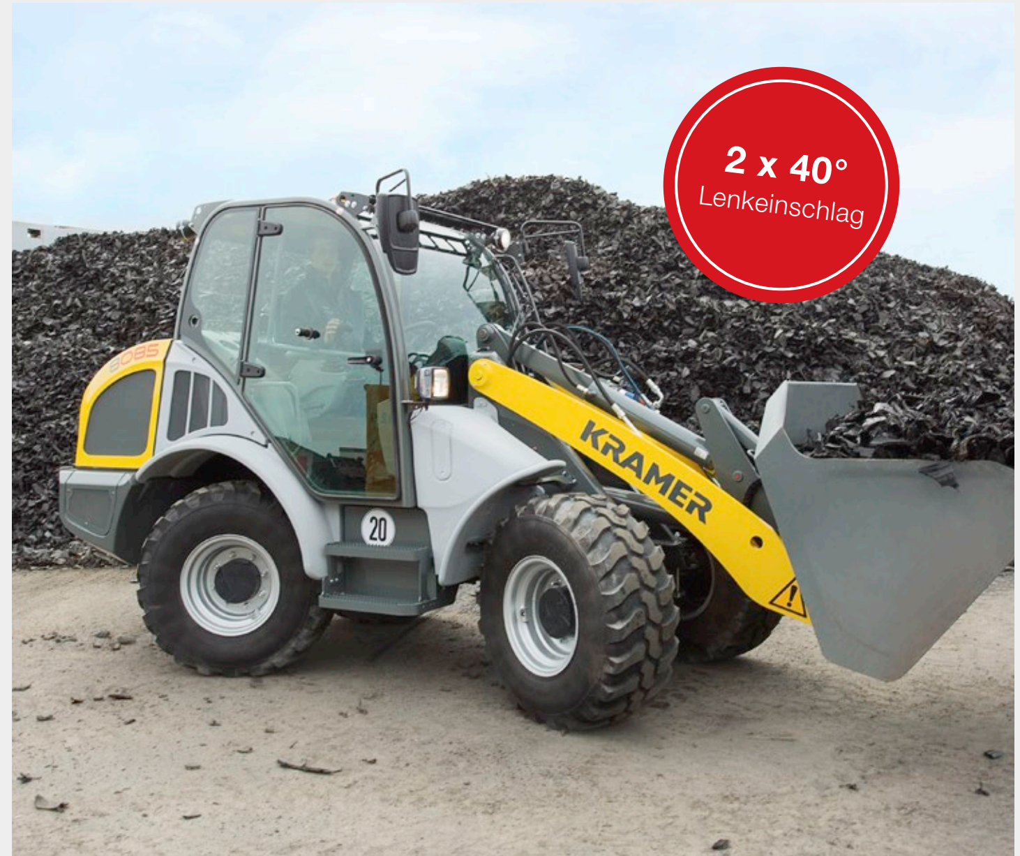
Allradlenkung besonders wendig bei eingeschränktem Platz
