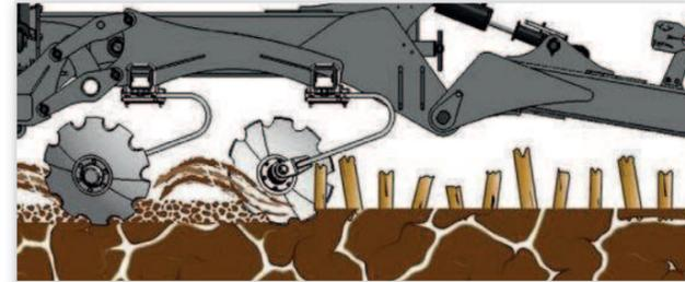
Das vordere Scheibenfeld schneidet Pflanzenreste, erzeugt Feinerde und hinterlässt gelockerte Streifen mit einer Mischung aus Boden und Pflanzenresten. Diese gelockerten Streifen (8 -15 cm Arbeitstiefe) befinden sich exakt zwischen den Zinken.
