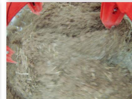
Heben und lockern. Der Boden wird wie ein Reißverschluss geöffnet und wieder geschlossen.
