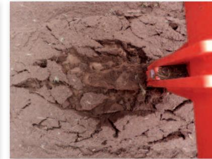
Klutenbrecher: Zerkleinerung von größeren Kluten. Teilt den Bodenfluss und verhindert, dass untere Bodenschichten nach oben befördert werden. Verschleißschutz für den Stiel.
