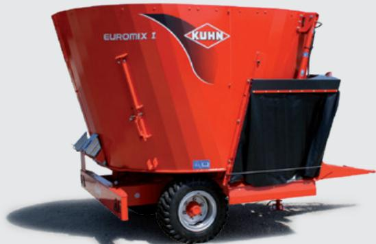
Mit Fassungsvermögen von 8, 10 oder 12 m<sup>3</sup> und einer Vertikalschnecke ermöglichen die Futtermischwagen der Serie EUROMIX I eine hochwertige Mischration. Die Behälterform und die Konzeption der Mischschnecke sorgen für einen ungehinderten Futterumlauf im Mischbehälter: Eine Garantie für eine homogene Mischung. Gegenschneiden, die oben angelenkt sind, bieten bei der Nachzerkleinerung eine große Schnittfläche.
