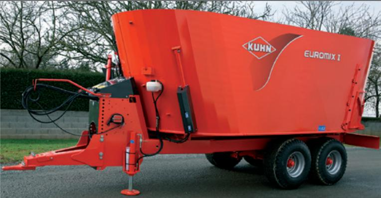
Die Baureihe der EUROMIX I mit zwei Vertikalschnecken ist schon mit Behältern ab 16 m<sup>3</sup> erhältlich und so ideal für niedrige Durchfahrten geeignet. Mit Modellen bis zu 22 m<sup>3</sup> wenden wir uns an Kunden, die einen Behälter mit großem Fassungsvermögen benötigen.
