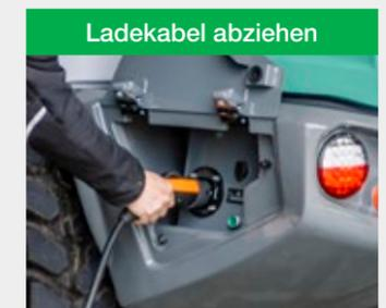
Druckschalter\* betätigen und Ladestecker abziehen. Anschließend Ladekonsole verschließen und Ladekabel verstauen.
