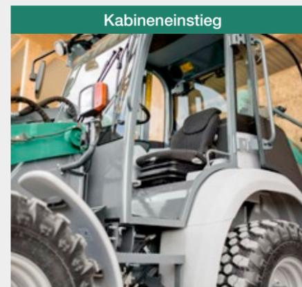
Die Fahrerkabine ist über den großzügig gestalteten Einstiegsbereich zu erreichen. Dank dem ungeteiltem Fahrzeugrahmen ist auch ein komfortabler Einsteig bei maximalen Lenkeinschlag möglich. Der Aufstieg ist treppenartig aufgebaut. Um dem Fahrer ein sicheres Ein- und Aussteigen zu vereinfachen, befinden sich die Haltegriffe in einer ergonomisch günstigen Position.
