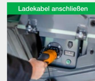
Ladekonsole öffnen und Ladekabel an die Maschine anstecken.
