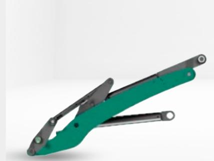
Die parallel geführte Ladeanlage gewährleistet konstante Hubkraft und eine sichere Bedienung im Materialumschlag. Durch einen Rückkippwinkel von bis zu 45° und einen Auskippwinkel von bis zu 45° verliert der Radlader im Schaufeleinsatz auch bei hohem Füllgrad kein Material und ermöglicht ein vollständiges Entleeren der Schaufel.
