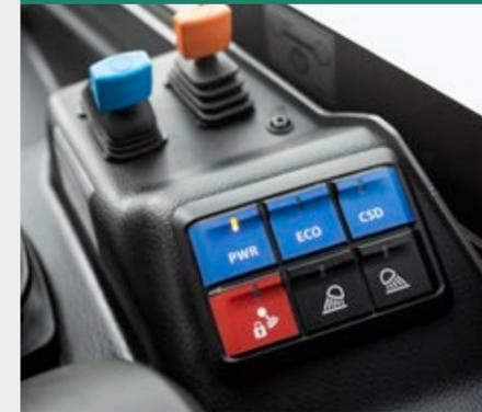
Das Feature beim KL14.5 umfasst drei per Knopfdruck wechselbare Fahrmodi, um der jeweiligen Anforderung möglichst effizient zu begegnen. Der Power Modus (PWR) eignet sich für Schaufelarbeiten, der ECO Modus für Stapelarbeiten oder Straßenfahrten und der Fahrpedalmodus (CSD) für hydraulische Anbaugeräte.
