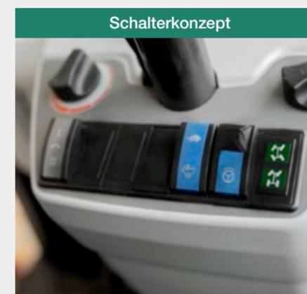
Durch die farblich gekennzeichneten Schalter ist die jeweilige Funktionsgruppe sehr schnell zu erkennen. Rot = Sicherheit, Grün = Hydraulik, Blau = Fahren und Grau = Elektrik. Hierdurch wird dem Fahrer eine bequeme und sichere Bedienung ohne Verwechslungsgefahr gewährleistet. Das Ergebnis ist eine erhöhte Arbeitseffizienz für den Fahrer.
