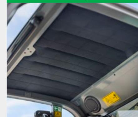
Die Kabine verfügt neben der Luftheizung optional über eine energiesparende Front- und Heckscheibenheizung, Sitzheizung sowie einer Flächenheizung. Dadurch werden gezielt bestimmte Bereiche erwärmt, anstatt das gesamte Luftvolumen. Die Flächenheizung befindet sich im Fahrzeugdach und unterhalb des Fahrersitzes. Zusätzlich ist die Kabine mit Dämmmatten gut isoliert, sodass die Wärme nicht verloren geht.
