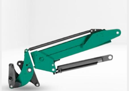
Die kompakte Kastenbauweise der Teleskopladeanlage macht die Sicht auf das Anbaugerät einzigartig. Die Vorteile der Z-Kinematik: Beim Einkippen der Schaufel wird bei gleicher Zylindergröße eine höhere Reißkraft erzeugt, da die Kolbenseite des Hydraulikzylinders beim Einkippen beaufschlagt wird.
