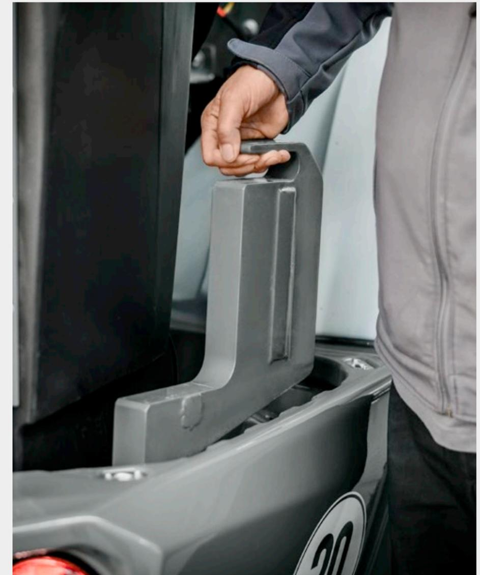
Die Smart Ballast Gewichte wiegen insgesamt 100 kg. Jedes Einzelne der acht Gewichte wiegt tragbare 12,5 kg.
