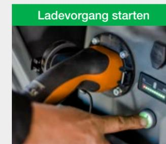
Druckschalter\* betätigen, um den Ladevorgang zu starten. Die Ladezustandsanzeige im Heck der Maschine beginnt zu blinken.
