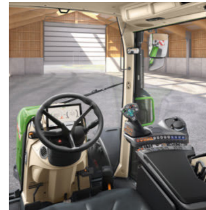
Power Setting 1 - Ohne Kreuzschalthebel - Ein Linearmodul (Rockerpaar) zur Bedienung Hydraulikventile
