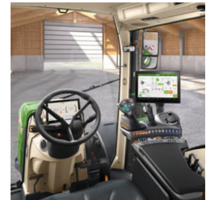
Profi+ Setting 2 - 3L-Joystick - Ein Linearmodul (Rockerpaar) zur Bedienung Hydraulikventile - 12" Terminal
