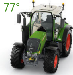
77° Panorama-Frontscheibe mit 77 Grad Sichtfeld für volle Sicht nach oben und auf die Radeinläufe.
