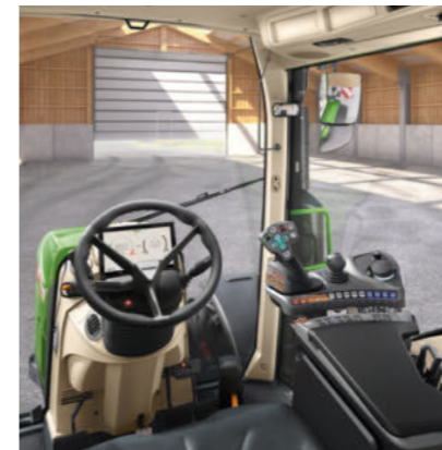
Power Setting 2 - Kreuzschalthebel - kein Linearmodul (Rockerpaar)
