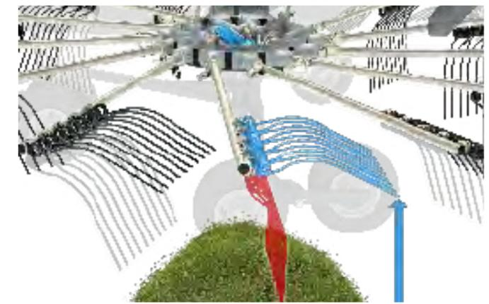
Aushubhöhe mit CamControl: Mehr als 50 cm Bodenfreiheit
