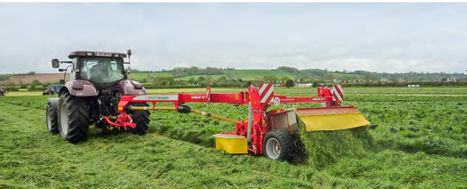
Nos faucheuses traînées NOVACAT T avec 3,04 m ou 3,46 m de largeur de travail sont parfaitement adaptées aux petits tracteurs. La version traînée avec chariot de transport nécessite moins de puissance de relevage ce qui vous permet de l'atteler à des tracteurs moins puissants. C'est ainsi que vous économisez du carburant.
