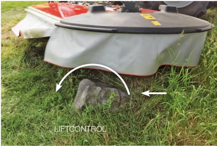
Sobald ein Hindernis angefahren wird, schwenkt die Mäheinheit dank LIFT-CONTROL zurück und nach oben. The Drehpunkt des Mähers befindet sich links neben dem Traktor, nicht mittig dahinter, so dass alle Trommeln optimal geschützt sind. Ausreichend Platz zwischen Drehpunkt und erster Trommel sorgt zusätzlich für besten Schutz.
