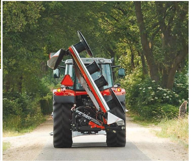
Beim Transport ist die Maschine in einem Winkel von 120° angeordnet. Ihr Gewicht wird dadurch gleichmäßig zwischen den Traktorhinterädern verteilt. Transportsicherheit und Fahrkomfort werden deutlich erhöht, und die Traktorbeleuchtung ist jederzeit deutlich sichtbar. Durch eine neue Geometrie des Zwischenrahmens konnte die Transporthöhe auf 3,60 m verringert werden, und das bei einer Bodenfreiheit von 40 cm. In Arbeitsposition beträgt die Bodenfreiheit des Zwischenträgers 50 cm.
