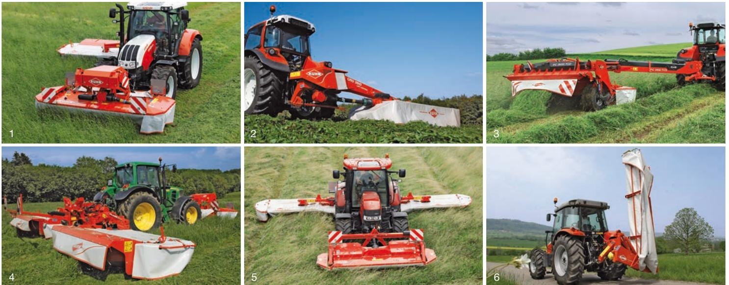
1. Front-Mähknickzetter – 2. Scheibenmäher mit horizontaler Einschwenkung – 3. Gezogene Mähknickzetter – 4. Dreifach-ScheibenMähknickzetter-Kombination
