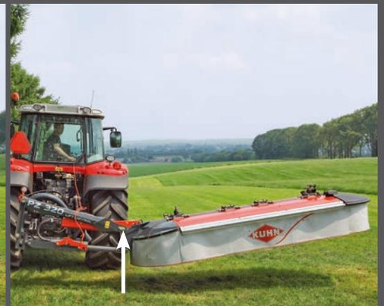
Der Zwischenrahmen befindet sich jederzeit in der optimalen Höhe: Tief genug beim Transport, hoch genug in Arbeits- und Vorgewendestellung.
