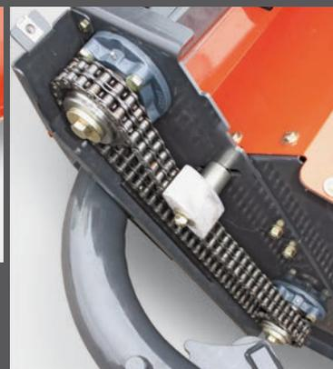
Die Aufbereiterdrehzahl (815 min<sup>-1</sup>) kann durch Austauschen der Zahnräder auf 650 min<sup>-1</sup> reduziert werden
