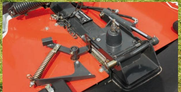
Hydraulisch klappbare seitliche Abdeckungen
