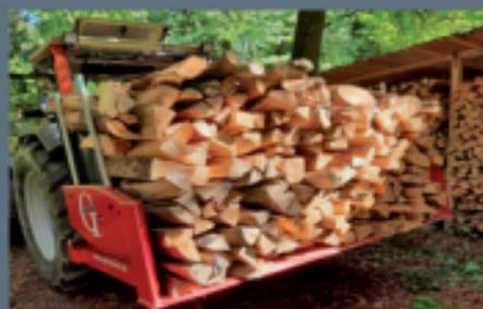
Die Heckklappe lässt sich manuell nach oben schwenken und verriegeln, zum Beispiel als Erhöhung zum Transport von Gütern. Die Heckklappe ist auch abnehmbar.
