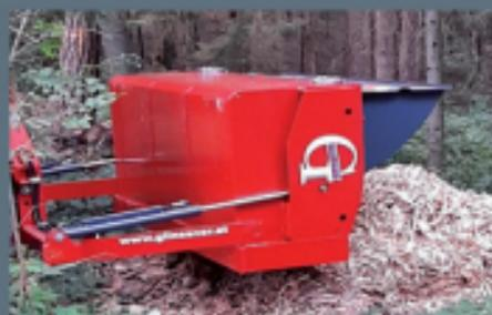
Mit stehender Heckklappe können Hubwagen ohne Anstieg direkt in die Heckschaufel gefahren werden.
