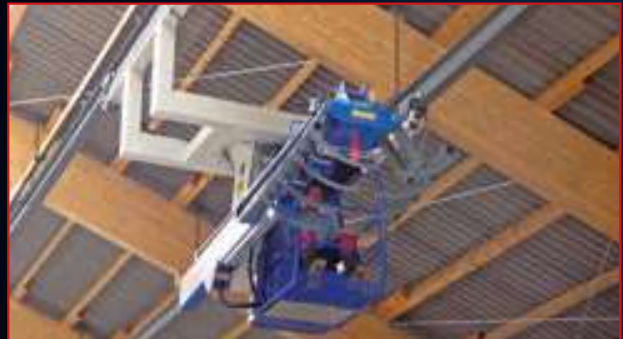
Einseitig abgesetztes Fahrwerk – optimale Anpassung am Gebäude (hydr. Greiferhochstellung).
