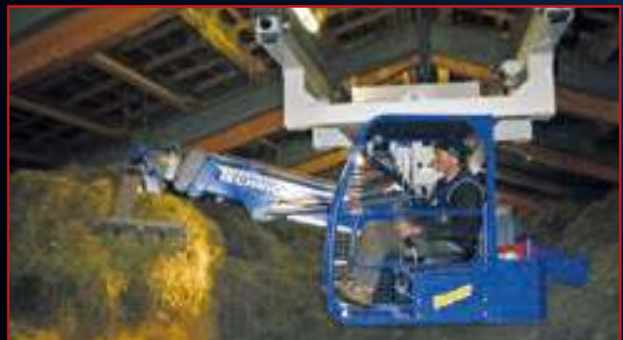
Beidseitig abgesetztes Fahrwerk unter dem Heuverteiler (hydr. Greiferhochstellung 130°).
