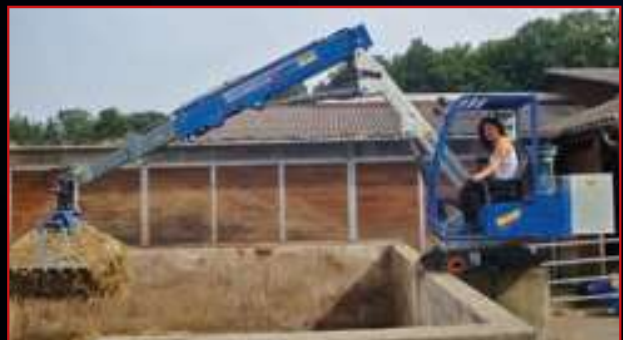
Stationär-/Mobilkrane in diversen Ausführungen, Greifer mit doppelten Laschen (Rotator mit Pendelbremse).
