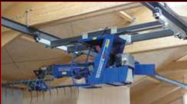
Hydr. Verschieberahmen mit Zylinder, Endlosrotator mit integrierter hydr. Greiferhochstellung seitlich pendelnd.
