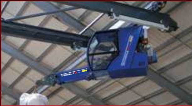
Querfahrwerke bis 34 m bieten bei breiten Gebäuden eine optimale Raumausnutzung (geschlossene Kabine mit Funk).
