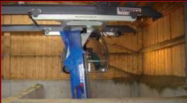
Querfahrwerk – optimale Übersicht und nahe an der schweren Last (Hubarm senkrecht nach unten).
