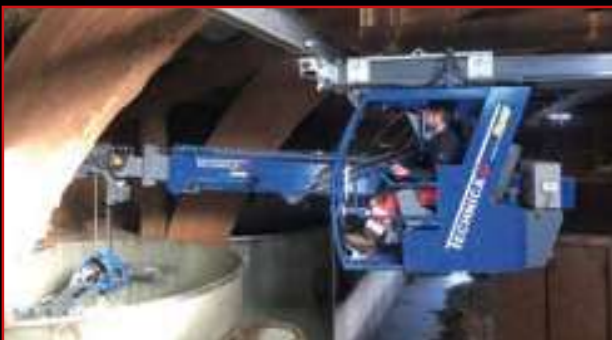
Hydr. Doppelkettenzugwinde mit gehärteter Führung und Antriebsnuss (hydr. Vorsteuerung, Kamera in der Kabine).
