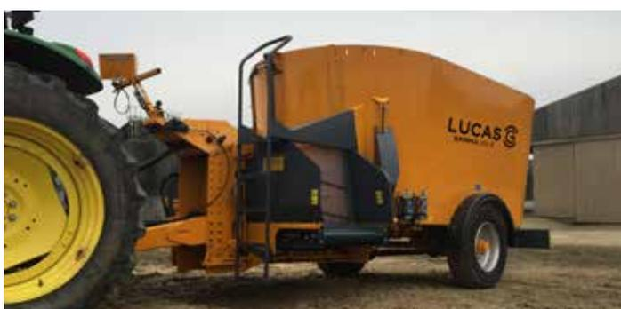
Les bols SPIRMIX S ont été développés pour les exploitations où l'encombrement des machines est un facteur important. Ces bols sont compacts et très maniables. En effet, l'essieu arrière a été intégré pour offrir une très faible hauteur hors-tout et un parfait comportement lors des phases de manœuvres. Ces bols bas trouveront facilement leur place dans les fermes avec une faible hauteur sous plafond.
