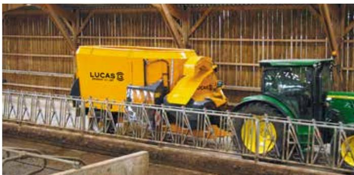
Les bols SPIRMIX ont été conçus pour une utilisation intensive et quotidienne. Ces mélangeuses sont adaptables en fonction de la configuration de l'exploitation, du type d'élevage. Ces mélangeuses possèdent un châssis indépendant de la cuve qui leur confère une capacité de circulation supérieure.
