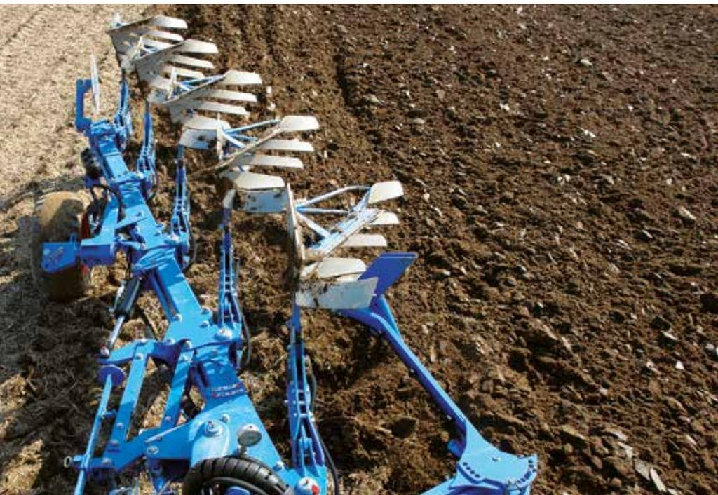
Un labour de qualité s'obtient grâce à une profondeur et une largeur de travail régulière. Ces caractéristiques sont réunies sur la charrue Juwel M V.
