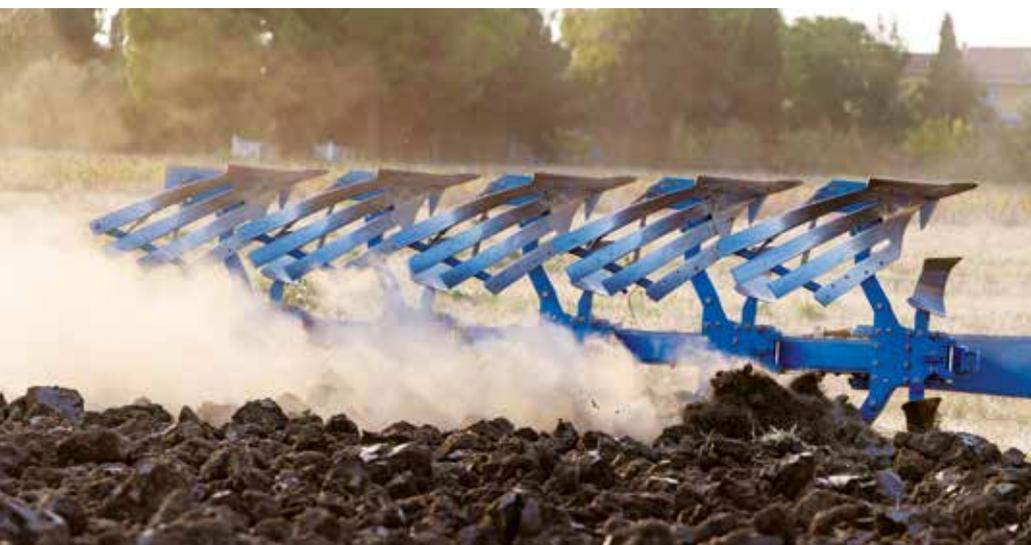
Châssis-poutre de 160 x 160 x 10 mm et axe de retournement de 130 mm de diamètre
