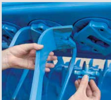
**Remplacement d'une dent à démontage rapide**
