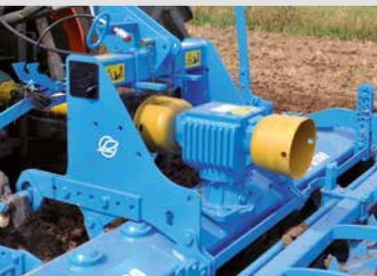
**Transmission simple grâce au couple conique interchangeable**
