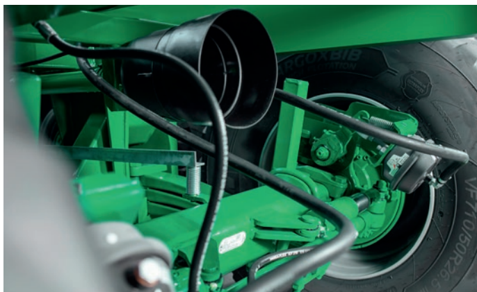
Das schwere BPW-Boggie-Fahrwerk mit ALB-Regler gehört zum Serienumfang des HS 220.
