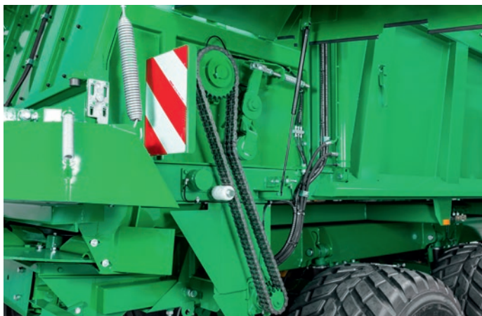
Der Fräsrollenantrieb erfolgt über eine Duplex-Rollenkette. Der massive Kettenspanner kann bei geschlossenem Schutzkasten kontrolliert und nachgespannt werden.
