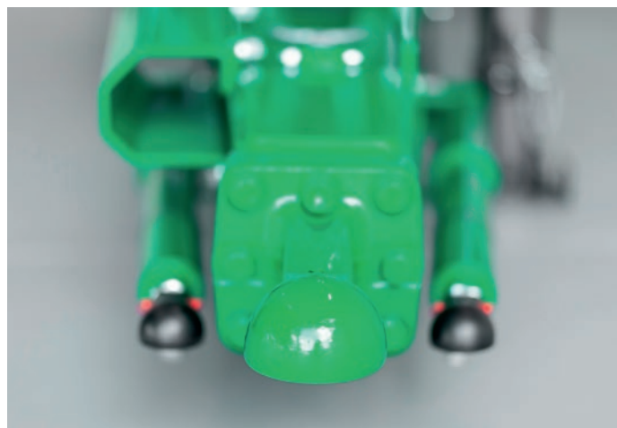
Bild unten: Streuer mit gefederter Untenanhängung können wahlweise mit einer drehbaren Zugöse Ø 50 mm oder dem Kugelkopfsystem Ø 80 mm ausgerüstet werden.
