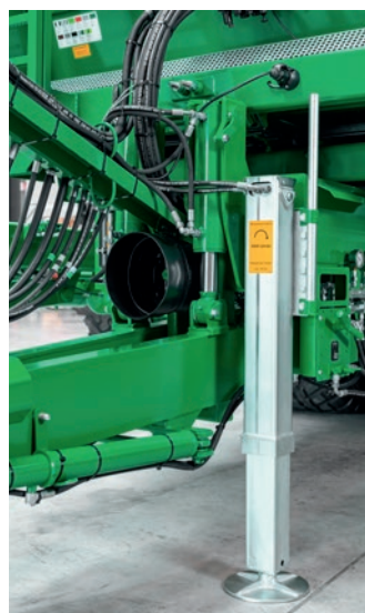
Bild links: Der hydraulische Stützfuß ermöglicht ein komfortables und schnelles An- und Abkuppeln des Streuers.
