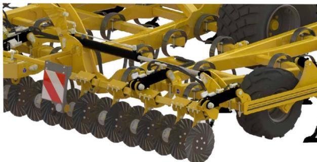
Pour repousser ses limites et **améliorer la qualité de mulchage**, il est possible d'équiper la machine d'une rangée de coutres circulaires frontales à réglage hydraulique qui **découperont les résidus les plus longs**.
