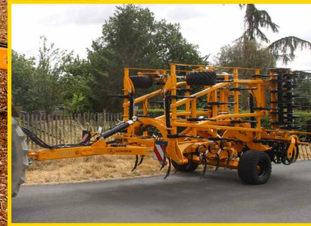
Les manœuvres en fourrières sont effectuées en tournant sur l'essieu situé entre la 4<sup>ème</sup> et la 5<sup>ème</sup> rangée de dents, ce qui permet **un gabarit compact et une grande maniabilité**.
