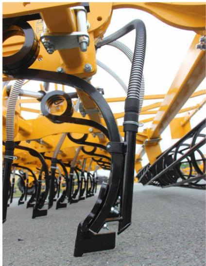
Équipé d'une pointe fine et d'une descente qui ont été spécifiquement développées pour le semis direct, les caractéristiques de dégagement et de capacité du Vibroseme SD permettent d'**assurer un semis direct d'excellente qualité**, et d'**assurer une excellente levée des cultures** même en conditions difficiles.
