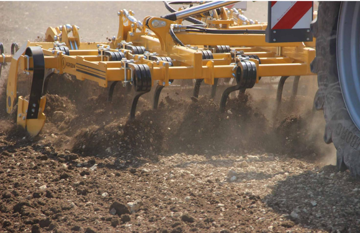
La gamme Vibromulch portés repliables 4,00 – 5,00 – 6,00 m et 7,00 m, destinés à des tracteurs de 120 à 280 ch est conçue à partir d'un châssis à 4 rangées de dents montées sur des poutres de 80x80 mm de section **offrant un dégagement de 60 cm sous bâti.**
