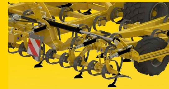
Le kit de **Cross-Board** frontal à réglage hydraulique, disponible sur l'ensemble de la gamme Vibromulch, permet de **niveler le sol** avant le passage des dents et d'**enfoncer les mottes** pour plus d'efficacité en reprise de labour et **préparation du lit de semence**.
