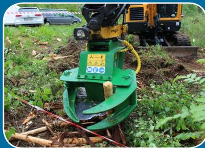
Der Energie-Schneider BC 18 von FARMA kann auch mit Baggern verwendet werden. Das Fällen, Sammeln, Schneiden und Laden von Baumstämmen über Buschwerk und Reisig bis hin zu Baumstümpfen ist damit ganz einfach. Bäume werden im Handumdrehen gefällt und die feste Klinge ist einfach zu warten. Der BC 18 ist mit diversen Baggeraufnahmen erhältlich oder aber mit einer Grundplatte.
