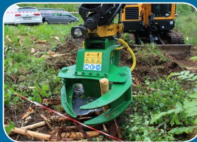
Der Energie-Schneider BC 18 von FARMA kann auch mit Baggern verwendet werden. Das Fällen, Sammeln, Schneiden und Laden von Baumstämmen über Buschwerk und Reisig bis hin zu Baumstümpfen ist damit ganz einfach. Bäume werden im Handumdrehen gefällt und die feste Klinge ist einfach zu warten. Der BC 18 ist mit diversen Baggeraufnahmen erhältlich oder aber mit einer Grundplatte.
