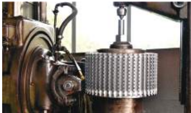
Herstellung von Kettenrädern
