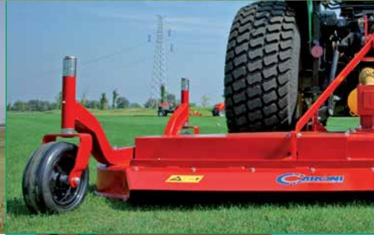
Les points d'attelage, standard, permettent d'utiliser tout type de tracteur. Pour les 5 premiers modèles, il existe sept points de graissage d'un accès aisément.
