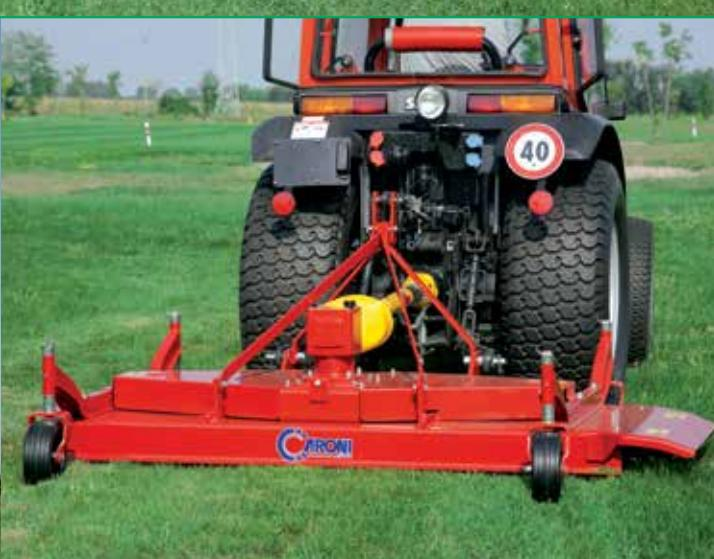
Der Standardanschluss ermöglicht die Anwendung durch jeden beliebigen Traktor. Für die ersten 5 Modelle gibt es sieben einfach zu erreichende Schmierpunkte.
