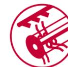
Der Federzinkenrotor und der mehrstufig verstellbare Aufbereiterkamm erzeugen mit ihren vielen ineinandergreifenden Arbeitswerkzeugen eine wellige, luftdurchlässige Futterstruktur und öffnen die oberste Blattschicht zur Erleichterung des Wasseraustritts.
