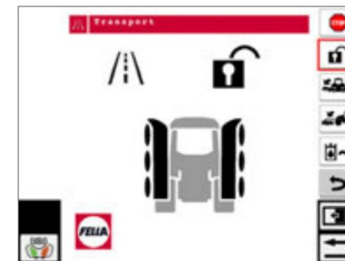
Eine recÄergestützte automatische Klappfunktion mit hydraulischer Transportsicherung erlaubt ein komfortables Umstellen auf Transportstellung und sichert zudem den Antriebsstrang der Maschine gegen Beschädigungen.
