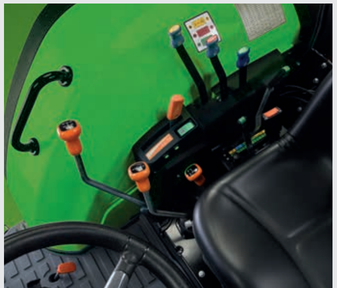
↑ Nouvelle disposition des commandes de distributeurs et du système EasyLift.
