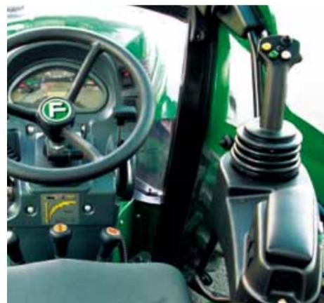
Bei der Version "Größere Hydraulikleistung" und bei Ausführung mit Joystick, ist auch ein Ölkühler vorgesehen. Der hydraulische Betriebsdruck beträgt max. 180 bar. Für die **Cromo K60** Modelle, in der Version ohne Joystick, sind bis zu 6 hinteren Hydraulikanschlüsse vorgesehen, welche den Einsatz von Werkzeugen ermöglichen, die eine große Durchflussmenge verlangen.
