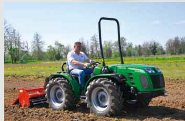
Die **Verteilung der Achslasten** zu 40% auf die Hinterachse und zu 60% auf die Vorderachse erweist sich als besonders vorteilhaft sobald ein Anbaugerät im 3-Punkt montiert wird, oder der Schlepper durch den Auflagedruck des Anhängers belastet wird. Es ergibt sich daraus eine verbesserte Stabilität und eine bessere Traktion. Der **permanente Antrieb der vier Räder** erleichtert bzw. ermöglicht das Arbeiten auf jedem Bodentyp.
